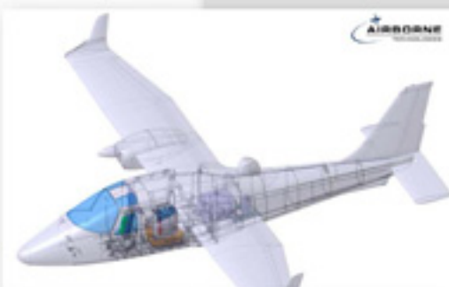
RIEGL LMS-Q1560安装在搭载于TECNAM MMA固定翼航测飞机上的GSM-3000陀螺座架中
