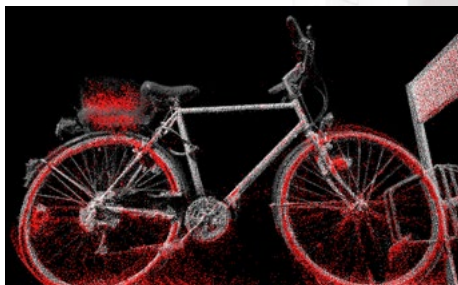
使用脉冲形状偏差属性信息， 自动选择无效的点
