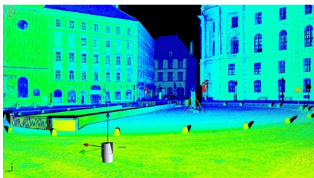
依据振幅强度范围显示的点云色彩
