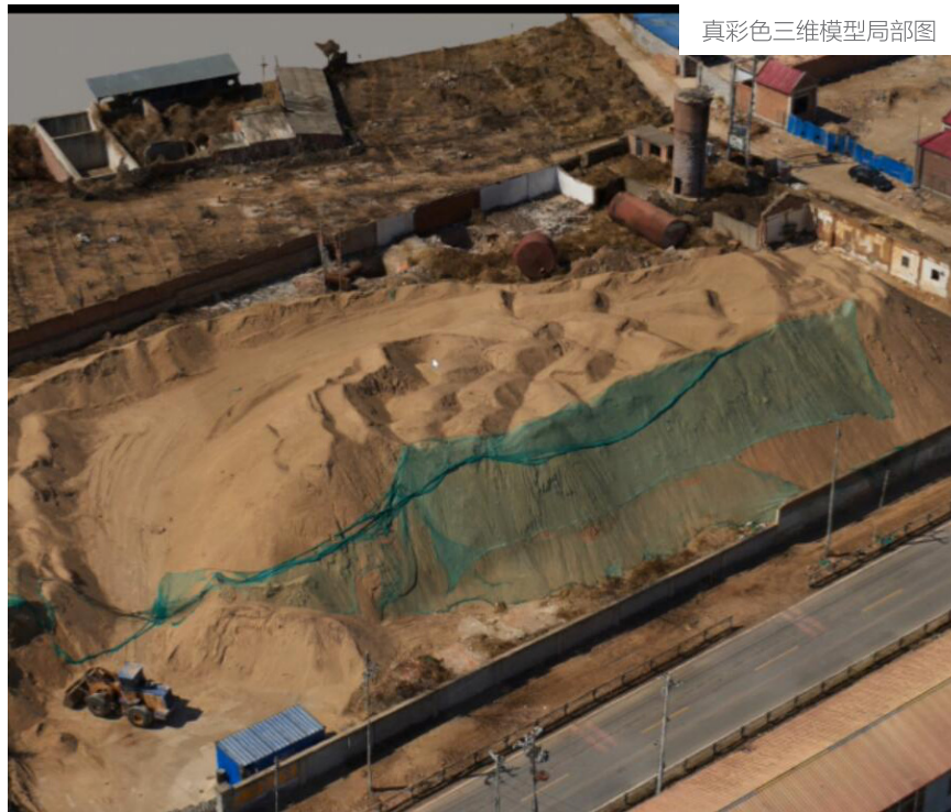
中画幅倾斜相机系统生成的真彩色三维模型
