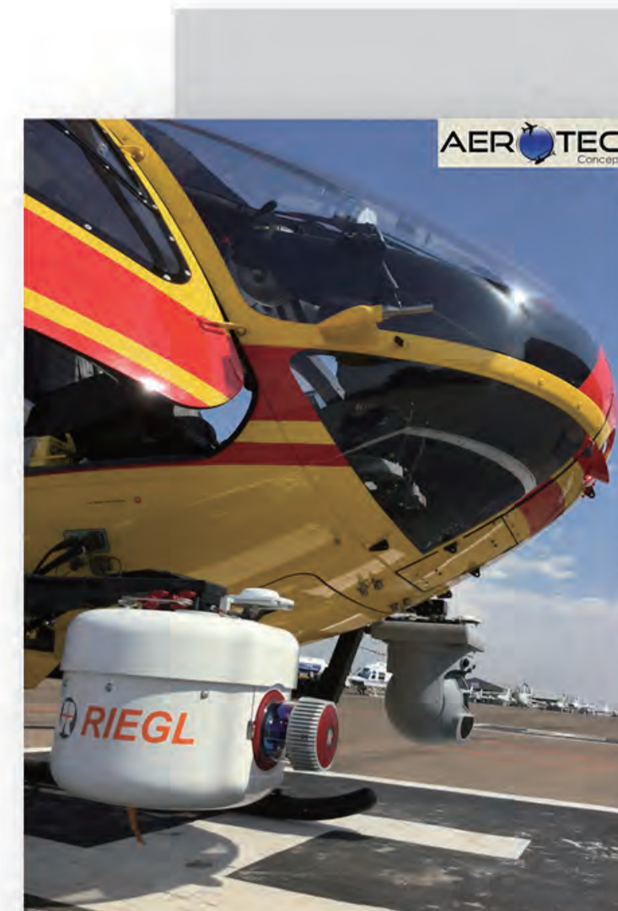
项目实例 安装在直升机(EC135)电力巡线
