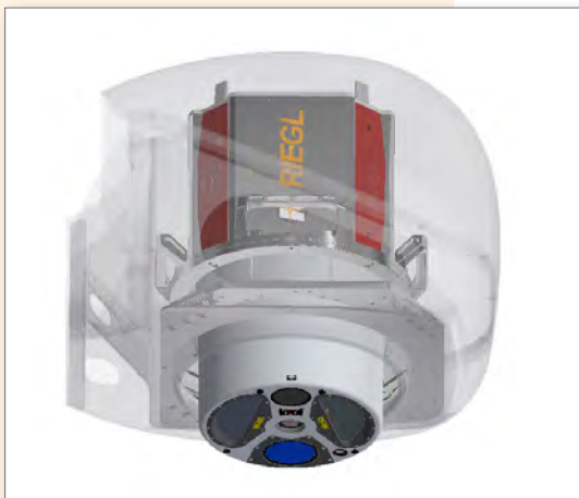
RIEGL VQ-1560 II 安装在DA42 MPP固定翼飞机机头罩内
