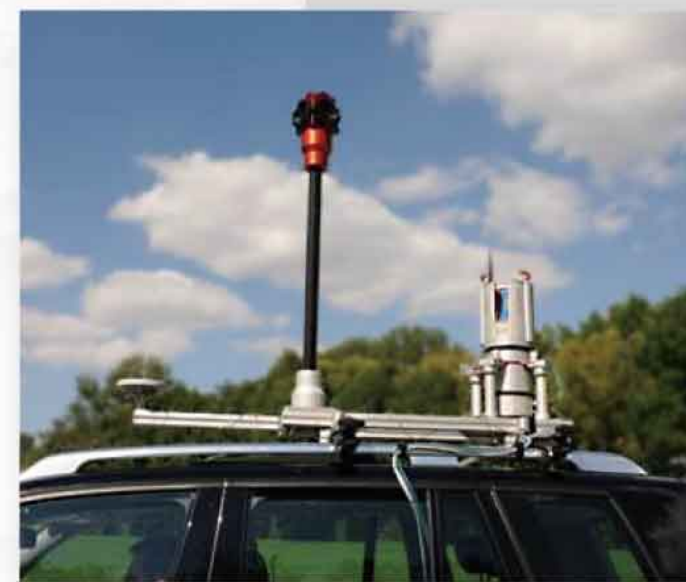
扫描仪垂直安装,配备全景相机系统
